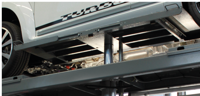
Fahrflächen-Hebebühnen mit Plattform-Radfreiheber, Schwelleraufnahme Traglast 3,5 t
