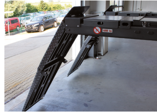
Klapp-Auffahrrampe bei hohen Fahrflächen oder geringem Auffahrwinkel
