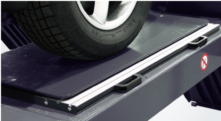
Präzisions-Schiebeplatte Minimales Losbrechmoment 5 Nm und minimale Verschiebekraft 15 N, Auffanggrillen für Schmutzwasser.
