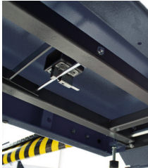
Befestigungssystem und Arretierung der Fahrflächenabstützung.
