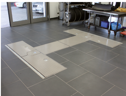
Vollständig abgedeckte Schwenkarmaufnahme mit Radlast 2 t überfahrbar
