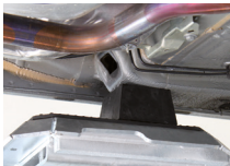
Pyramidenklotz für punktgenaue Aufnahme und hohe Bewegungsfreiheit unter dem Fahrzeug.
