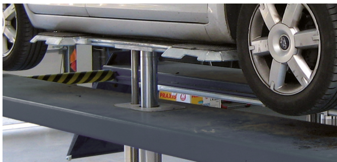
Fahrflächen-Hebebühnen mit Flachträger-Radfreiheber, Schwelleraufnahme Traglast 3,5 t
