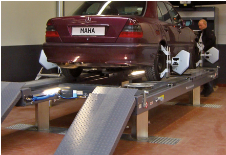
Hohe Genauigkeit als Achsmesshebebühne
