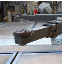
Unterschwenkhöhe am Aufnahmeteller von 101 mm
