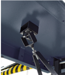
Befestigungssystem und Arretierung der Fahrflächenabstützung.
