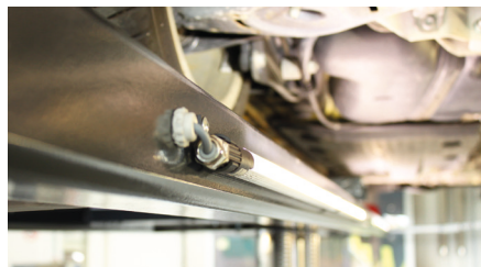
Drehbare LED-Beleuchtung zum einfachen Einstellen der Lichtrichtung, um blendfrei zu sehen.
