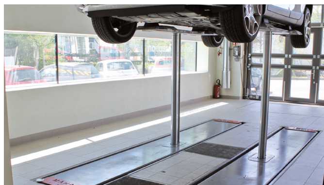
Fahrzeug am Schweller gehoben
