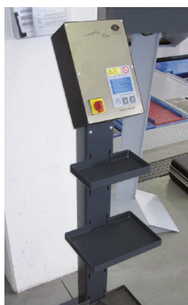
Steuerung auf einer Funktionsstandsäule, zur freien Aufstellung montiert
