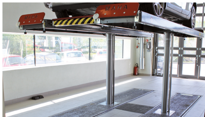
Fahrzeug an den Rädern gehoben
