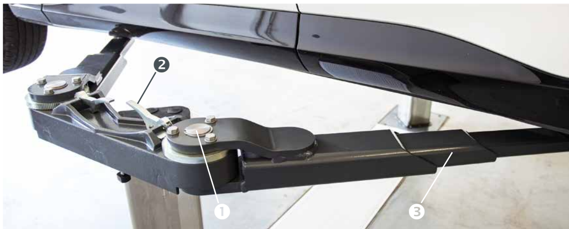
Schwenkarmträger mit Werkzeugablage.
