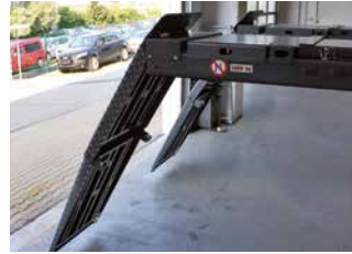
Klapp-Auffahrrampe bei hohen Fahrflächen oder geringem Auffahrwinkel
