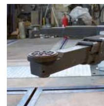
Unterschwenkhöhe am Aufnahmeteller von 101 mm
