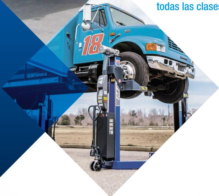
La rigidez mecánica extraordinaria de las columnas de elevación garantizan la seguridad y funcionalidad bajo todas las condiciones
