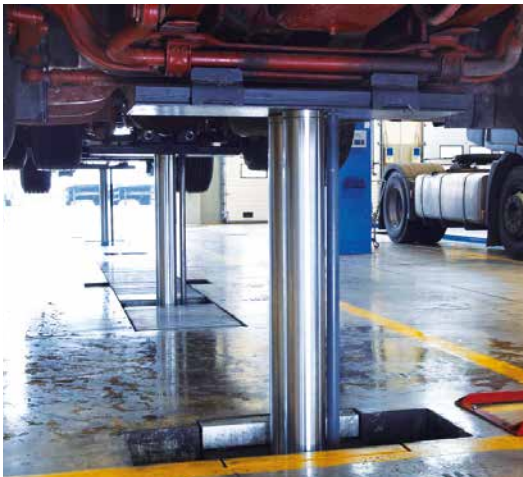
Alle MAHA TRUCKLIFT-Anlagen verfügen über eine Gleichlaufregelung nach DIN EN 1493.
