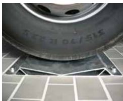
Radmulden dienen als Positionierungshilfe bei der Aufnahme der Fahrzeuge. Sie können ortsveränderlich oder fest installiert werden.
