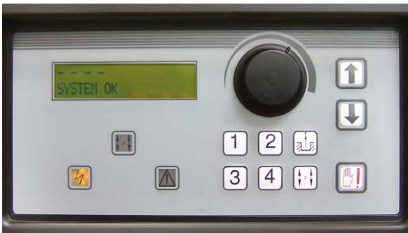
Serienmäßig mit elektronischer Gleichlaufsteuerung der kompletten Hebeanlage, mit Abnahme nach DIN EN 1493.
