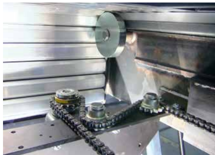
Sichere Kettenführung zur genauen Positionierung der Hubeinheiten
