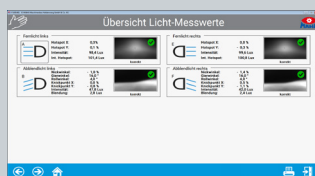
Lichttest Digitale Ermittlung der Scheinwerfereinstellung mittels CMOS-Kamera.
