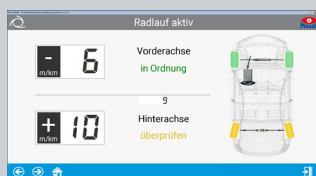
Radlaufstest Übersichtliche Darstellung des Gerauslaufverhaltens der Fahrzeugachsen.
