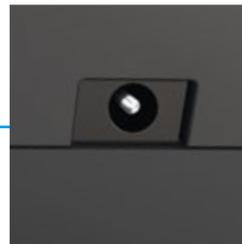
Spannungsversorgung via Hohlstecker
