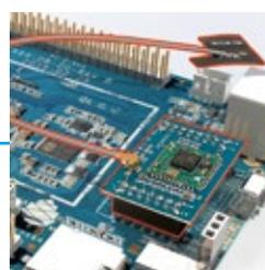
Integriertes WiFi-Modul zur Erstellung eines eigenen Netzwerks (als Master) oder Integration in ein bestehendes Netzwerk (als Client)
