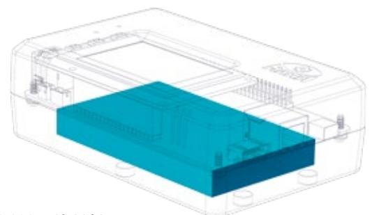
10.000 mAh Lithium-Polymer-Akku mit einer Laufzeit von ca. 10 h
