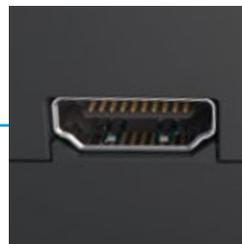
HDMI-Schnittstelle zur Übertragung an Monitor oder TV
