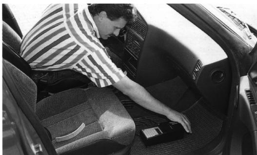
Positionner le VZM 300 dans le sens de conduite, sur une surface anti-dérapante, dans le véhicule. Utiliser un tapis de sol en caoutchouc ou un support similaire.
