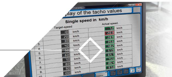
Wegstreckenmessung mit optional bis zu zehn frei wählbaren Prüfpunkten
