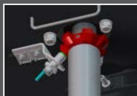
Höhenmessung durch berührungslose, verschleißfreie induktive Näherungsschalter.
