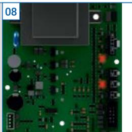
Einfache, optische Fehlerdiagnose durch die auf der Platine angebrachten Leuchtdioden.
