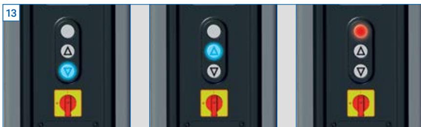
Obere Endposition oder Deckenlichtschranke erreicht. Nur Senken möglich. Senken-Taste leuchtet blau.
