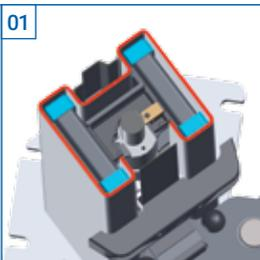
Höchste Präzision durch industriell gerolltes Säulen-H-Profil (Origamitechnik, schweißnahtfrei!) – patent pending.
