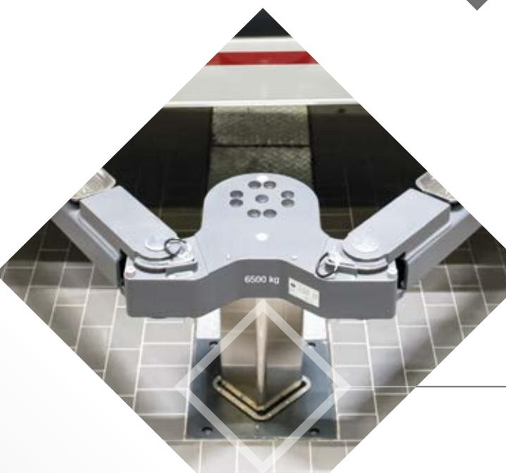
Herausragende Steifigkeit und höchste Sicherheit durch verwindungssicheren Vierkant-Stempel
